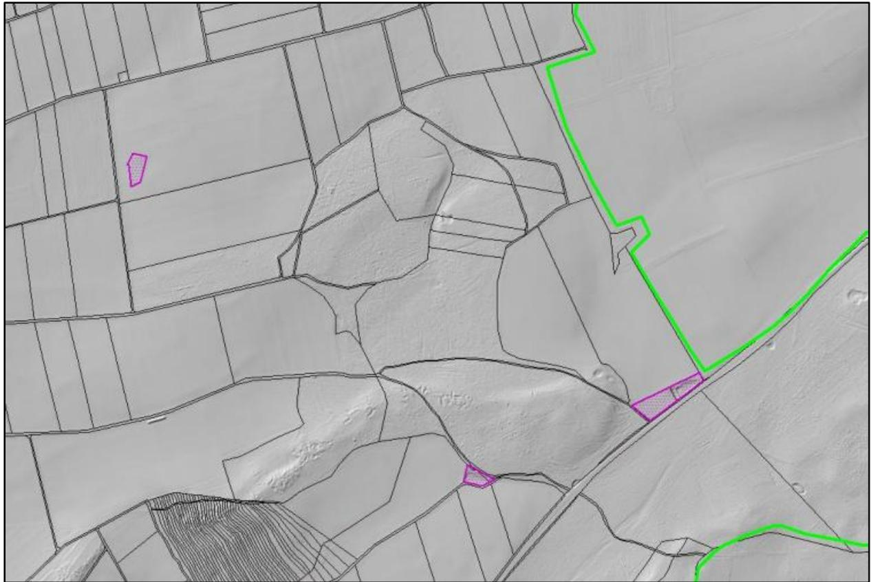
Abbildung 17: Lageplan mit lila gekennzeichneten Flächen, die auf einen Verdacht von nicht qualifizierten Auffüllungen hinweisen, o. M.
