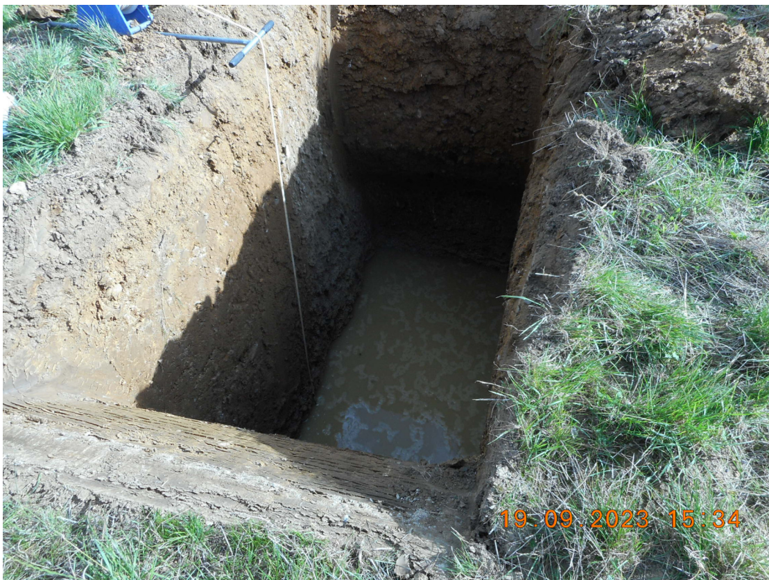
Abb. 4: Sickerversuch an Schurf S2/190923
