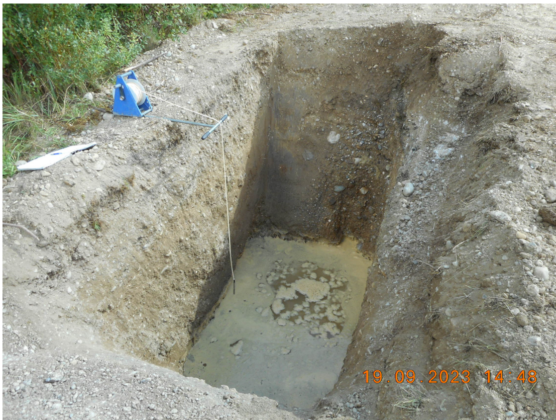
Abb. 2: Sickerversuch an Schurf S1/190923
